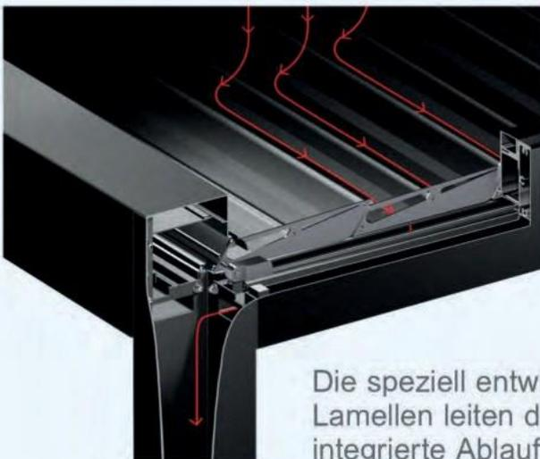
Die speziell entwickelten Aluminium Lamellen leiten das Wasser in die integrierte Ablaufrinne.
